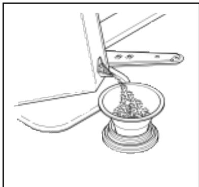
De afwasmachine is uitgerust met een automatische waterverzachter die de harde bestanddelen aan het water onttrekt.
