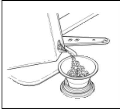
Ihr Geschirrspüler ist mit einem Enthärter ausgerüstet, der dem Wasser den Kalk entzieht, der sonst zu Verkrustungen oder Beschädigungen des Gerätes führt.
